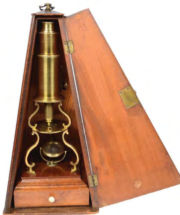
Fig. 10 - Antico microscopio inglese della fine del XVIII sec di ottone e legno modello Culpeper. È un antico strumento ottico nel quale il tubo ottico a forma cilindrica è retto da 3 supporti innestati su una base in legno con cassetto contenente gli accessori. Il microscopio è corredato della sua scatola originale in legno di mogano a forma di piramide. Altezza microscopio cm 31. Misure scatola larghezza cm 18x18 altezza cm 42.
